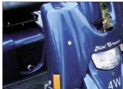
Beinschutzschirm Beinschutzschirm für Mini Crosser M- und MaxX. M-127-1-023 – Nur für 3W, am 4W ist es integriert.
