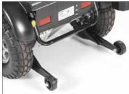
Anti-Kipp-Räder Stützräder mit Anti-Kipp-Funktion
