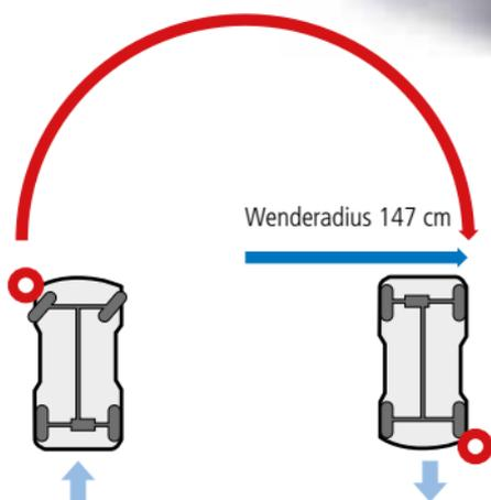
Kompakt und wendig – der sehr komfortable Agin mit hoher Manövrierfähigkeit und ca. 35 km Reichweite sorgt für beste Mobilität. Die Geschwindigkeit lässt sich stufenlos regulieren und über die ergonomisch geformten Wippen leicht dosieren. Ein drehbarer Komfortsitz zum bequemen Auf- und Absteigen gehört ebenso dazu wie die komplette Sicherheitsausstattung.
